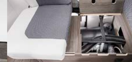
4 Il riscaldamento diesel posta nel soggiorno
