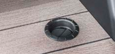
1 Presa d'aria calda aggiuntiva
