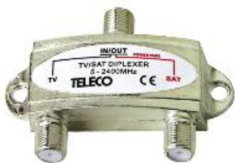
FB1 D Cod.07993 Mix Demix da interno 5 - 862 MHz 950 - 2400 MHz
