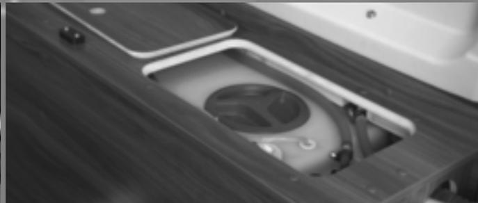
**2 aperture di manutenzione per il serbatoio dell'acqua**
