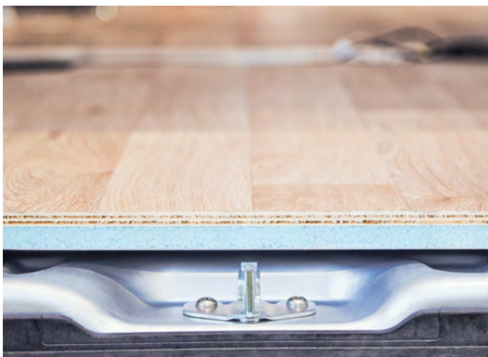
Plancher 25 mm avec isolation Styrofoam et sous-bassement polyester
