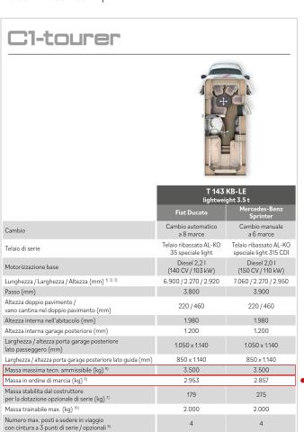
La massa massima tecnicamente ammissibile del veicolo (ad es. 3.500 kg) non deve mai essere superata quando il veicolo è in marcia. Viaggiare con un veicolo che supera la massa massima tecnicamente ammissibile costituisce una violazione del regolamento passibile di sanzioni. Pertanto raccomandiamo tassativamente di verificare e sincerarsi prima di ogni viaggio di non superare la massa massima tecnicamente ammissibile a pieno carico (ad es. 3.500 kg).
