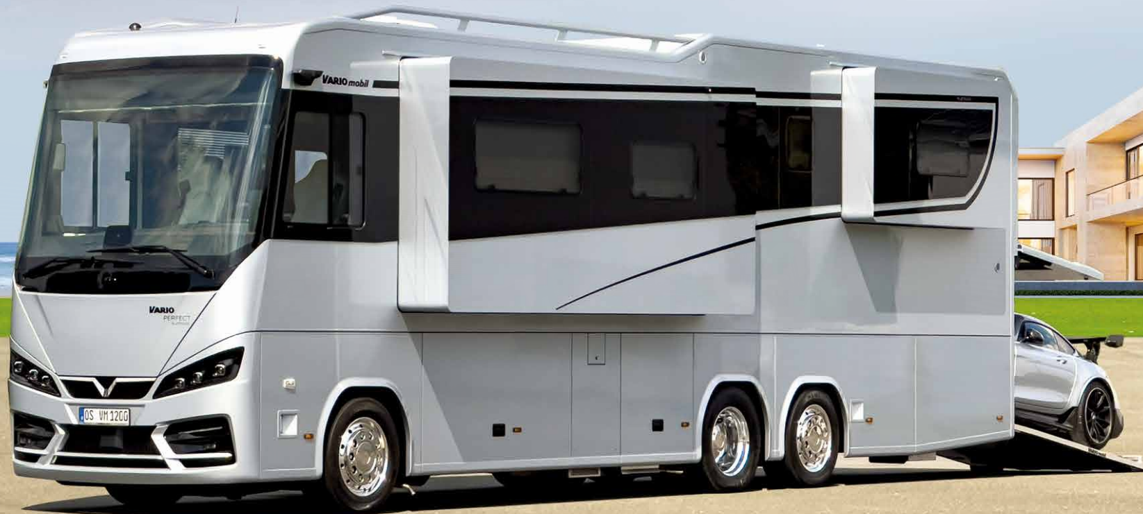
VARIO SLIDE OUT - pneumatisch dichtend, Beheizung der Außenfläche, exakte Spaltmaße von Erkersystem, Türen und Klappen, hochwertiges Autolacksystem, elegante Metalllackierung rundum
