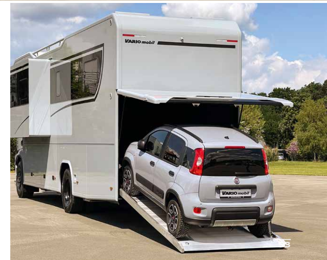
VARIO ALKOVEN 1050 auf MB Actros 1846 LHAD | Semi-Offroader | zusätzlich zum Heckantrieb: Hydraulikmotoren an der Vorderachse | Heckgarage für Mini-SUV, z.B. Panda
